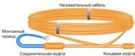
Нагревательная секция состоит из 2-жильного нагревательного кабеля, который с одной стороны имеет концевую муфту без выводов, а с другой - соединительную муфту и монтажный провод. 2-жильная конструкция нагревательного кабеля позволяет подключать нагревательную секцию с одного конца, что значительно упрощает её монтаж.
