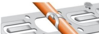
Лепесток выступает над поверхностью ленты, что облегчает его загиб, например, отверткой. Небольшой отгиб на конце язычка обеспечивает надежное закрепление кабеля «в замок». Зажимы расположены с постоянным шагом равным 2,5 см.
