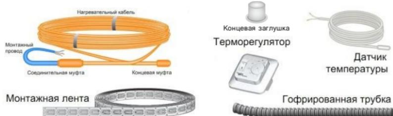
Нагревательная секция - это 2-жильный нагревательный кабель определенной фиксированной длины с монтажными проводниками для подключения к электрической сети. Соединения нагревательного кабеля с монтажными проводниками и концевая заделка нагревательного кабеля выполнены в герметичных соединительных и концевых муфтах, которые проходят многократные заводские испытания на механическую прочность и электрическую надежность.
