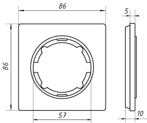
Модульная конструкция многопостовых рамок обеспечивает межосевое расстояние между приборами 71 мм.
