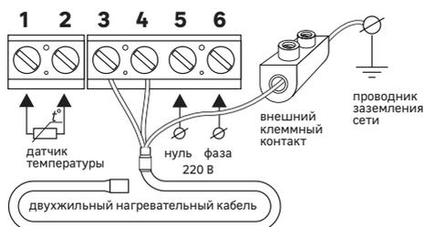
Схема подключения к электрической сети
