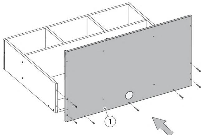
**Шаг 7.** К столешнице (поз. 1) нужно прикрутить винты эксцентрика (поз. 26)
