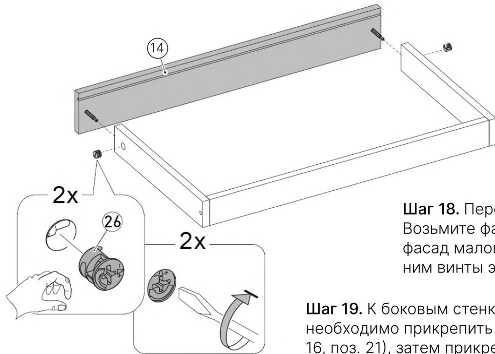
**Шаг 18.** Переходим к сборке ящиков. Возьмите фасад большого ящика (поз. 14) и фасад малого ящика (поз. 18). Прикрутите к ним винты эксцентрики (поз. 26)
