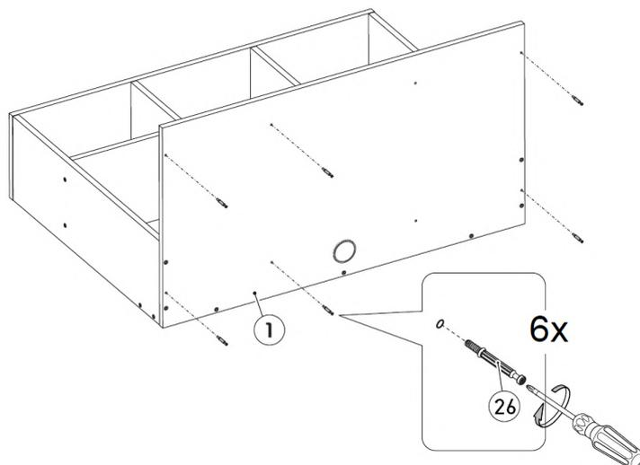
**Шаг 8.** Верхняя часть корпуса будущего стола готова, теперь приступаем к сборке нижней части корпуса. Для этого находим следующие детали: правая стенка корпуса (поз. 4), левая стенка корпуса (поз. 2) и промежуточную перегородку (поз. 3). Сперва на все детали необходимо прикрутить винты эксцентрика (поз. 26). Дополнительно в отверстия на перегородке (поз. 3) необходимо установить двойной шток эксцентрика (поз. 27)
