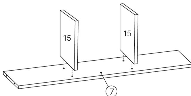
**Шаг 2.** К полученной конструкции прикрепите две перегородки (поз. 15) при помощи евровинтов (поз. 24)
