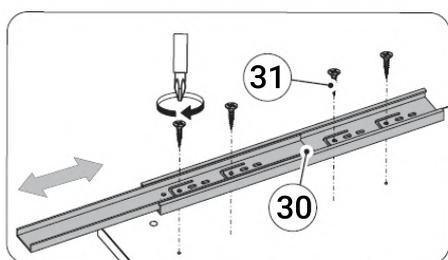
**Шаг 16.** При помощи саморезов (поз. 19) устанавливаем внешние части направляющих на перегородку (поз. 3), левую (поз. 2) и правую перегородку корпуса (поз. 4) при помощи саморезов (поз. 31). Обратите внимание на разметку.
