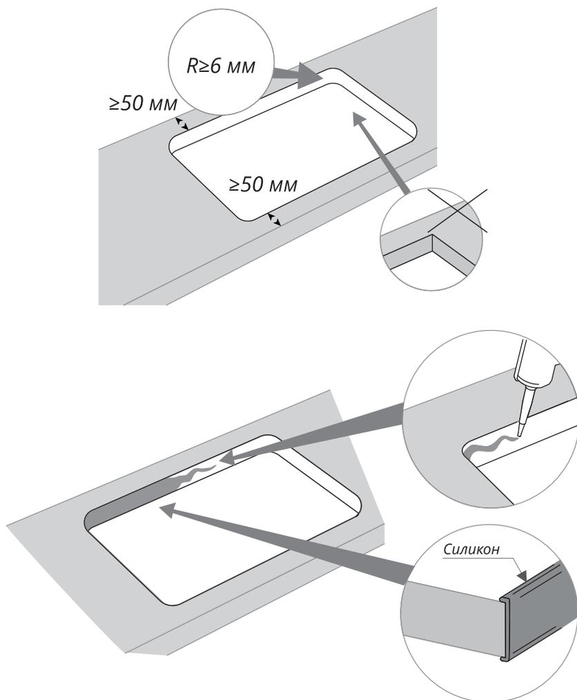
Минимальное расстояние между выпиленными отверстиями и краем столешницы должно составлять не менее 12 см по длине столешницы.
