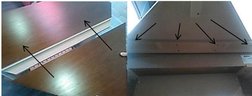
6. Закрепить упорную рейку саморезами (41x3,5 2 шт.) с задней части портала (см. фото).
