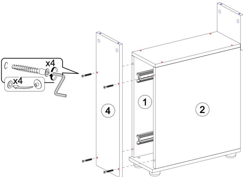
8. Ввернуть штоки эксцентриков в отверстия на крышке (5)
