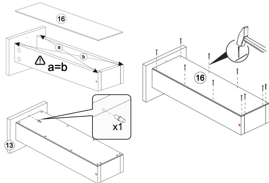
14. В отверстие на фасаде ящика (13) вставить полкодержатель
