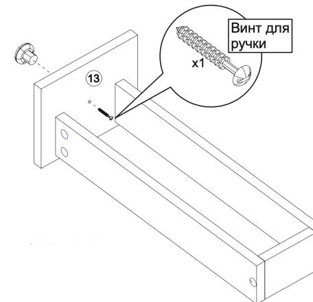
11. Ввернуть штоки эксцентриков в фасад (13) и присоединить его к бокам ящика (10) и (11), зафиксировав его эксцентриками
