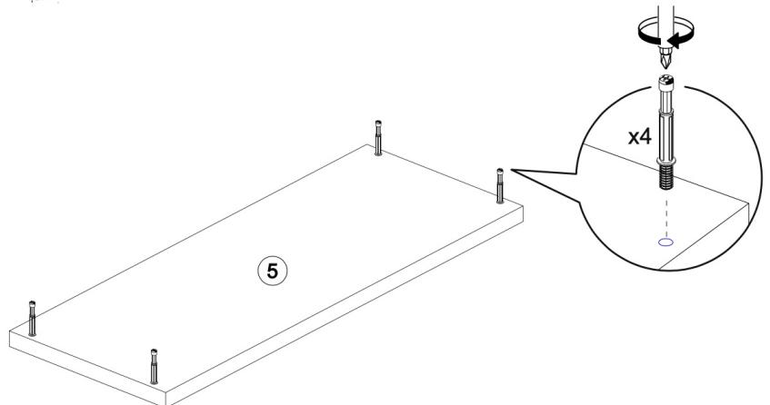
9. Присоединить крышку (5) к задней стенке (4) и накладке (12), зафиксировав стяжками эксцентриков. Установить заглушки эксцентриков
