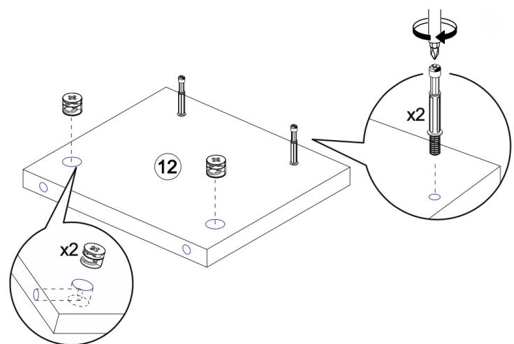
5. Установить на полке (7) эксцентрики в соответствующие отверстия.
