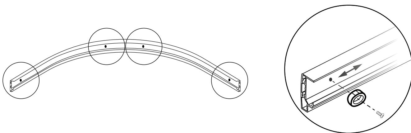
Установите ограничители двери (A) на верхние и нижние дуги (F) саморезами (I). На дугах уже отмечены отверстия для установки.
