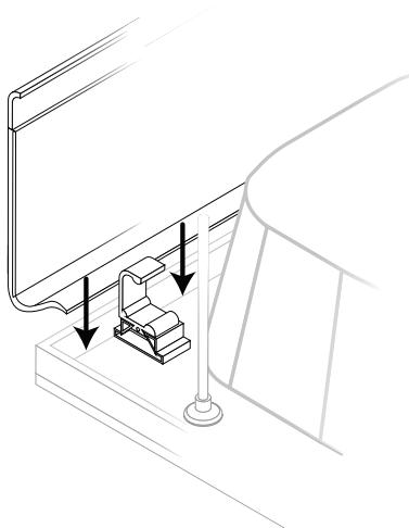
**4.** Установите экран на поддон, экран вставляется в проем между крепежом экрана и загибом поддона.
