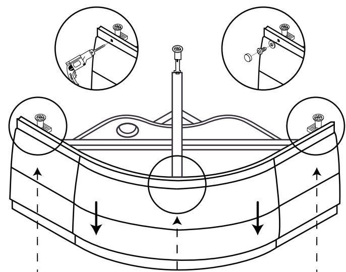
**5.** Просверлите отверстия в экране и в крепеже экрана, установленного на шпильки. Вставьте саморез 21,5 см в уплотнитель и закрутите в отверстие. Установите заглушку.
