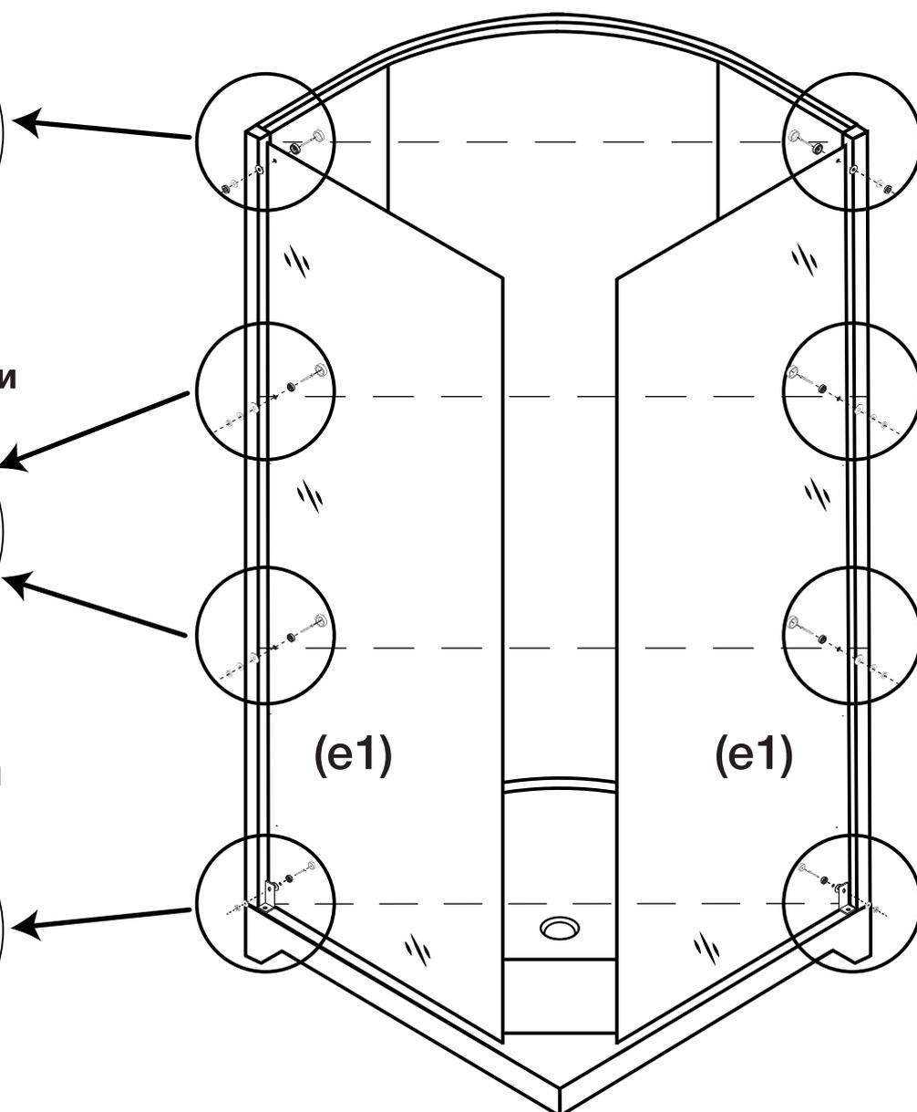
3. Соедините задние стенки (e1) с центральной панелью (h1)
