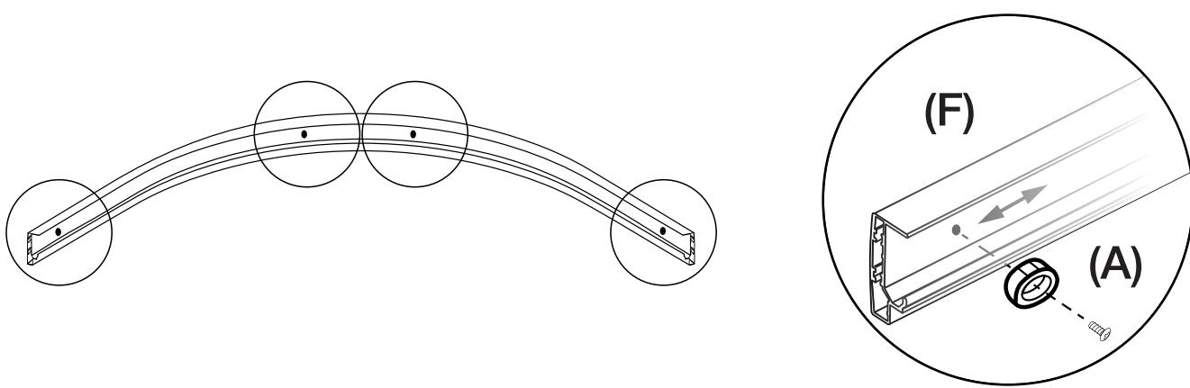
Установите ограничители двери (A) на верхние и нижние дуги (F) саморезами (B). На дугах уже отмечены отверстия для установки.
