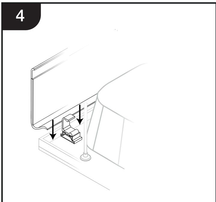
4. Установите экран на поддон, экран вставляется в проем между крепежом экрана и загибом поддона.
