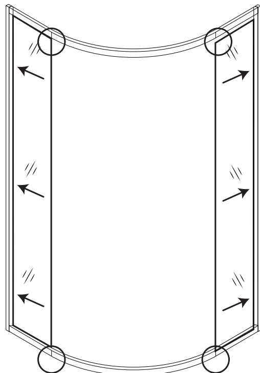
**5 Сборка задних стенок, центральной панели, фронтальной части**
