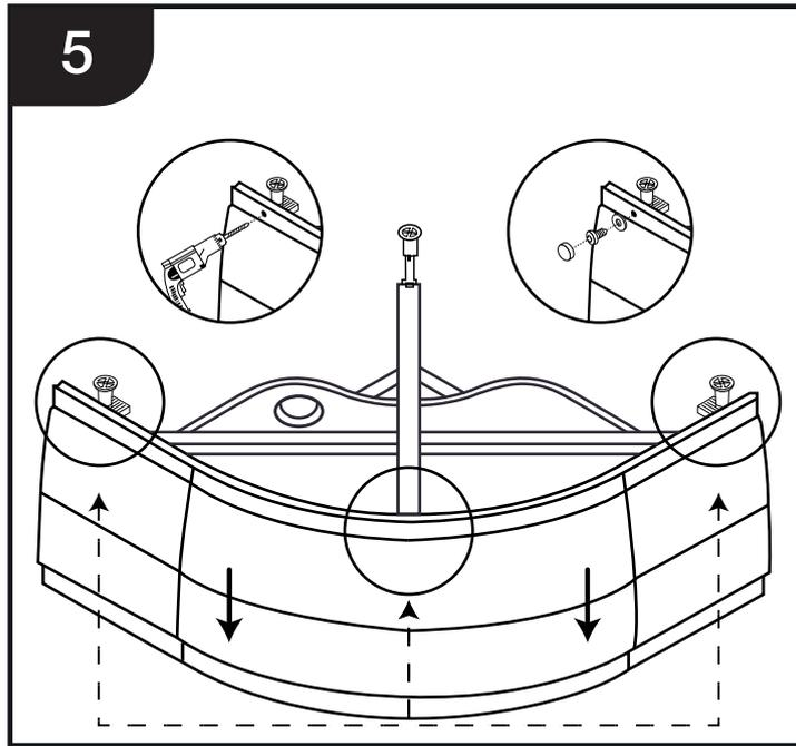
5. Просверлите отверстия в экране и в крепеже экрана, установленного на шпильки. Вставьте саморез 21,5 см в уплотнитель и закрутите в отверстие. Установите заглушку.
