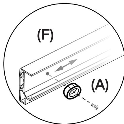
Установите ограничители двери (A) на верхние и нижние дуги (F) саморезами (B). На дугах уже отмечены отверстия для установки.
