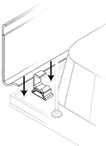
**4.** Установите экран на поддон, экран вставляется в проем между крепежом экрана и загибом поддона.
