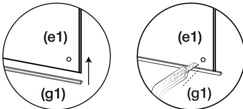
2. Поставьте на поддон лицевую часть душевой кабины. Соедините задние стенки (e1) с фронтальной частью с помощью крепежей (m1) / (k1)
