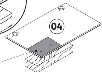
**RU:** Выберите положение ручек и разметьте отверстия с помощью шаблона. Просверлите отверстия Ø 5 мм для их установки.
