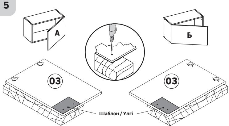
**RU:** Выберите положение ручек и разметьте отверстия с помощью шаблона. Просверлите отверстия Ø 5 мм для их установки.
