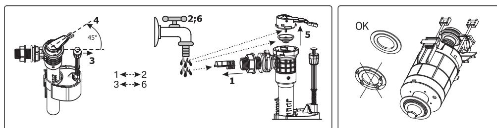
ИНСТРУКЦИЯ ПО МОНТАЖУ ШУМОПОГЛОЩАЮЩЕГО УПЛОТНИТЕЛЯ
