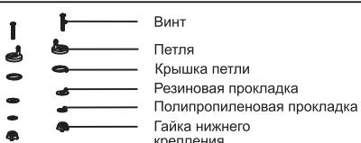
Установка верхнего крепления. Вставьте детали последовательно в керамические отверстия в соответствии с рисунком. Не зажимайте петли сильно, обеспечьте им регулируемое положение.
