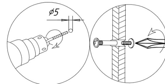
**Инструкция по сборке каркасов шкафов Лион**
