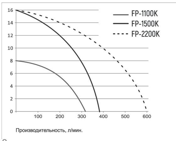
Производительность насоса напрямую зависит от напора (высоты подъема воды). Не рекомендуется использовать насос при максимальном напоре – в этом случае подача воды будет минимальна;
