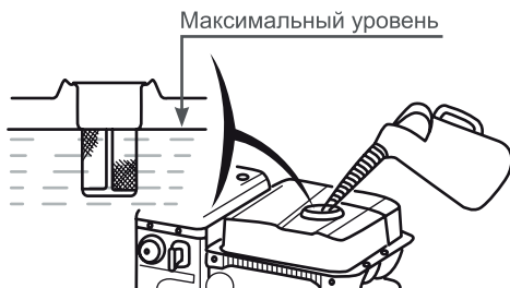
Рис. 14 Максимальный уровень топлива в баке
