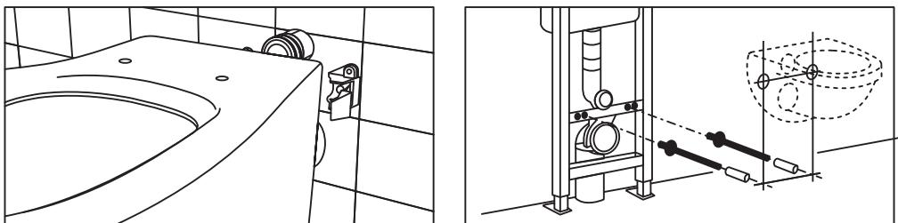
2. Произведите обшивку места установки инсталляционной системы (руководствуйтесь допусками завода изготовителя инсталляции).
