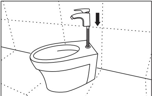
1. Закрепите в технологическом отверстии чаши биде собранный смеситель согласно инструкции по монтажу (поставляется в комплекте со смесителем).
