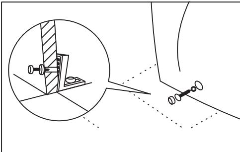
4. Вставьте винты в установочные отверстия и затяните их, после чего, на шляпки винтов наденьте декоративные колпачки.
