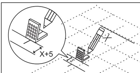
3. Обработайте манжеты и выпуск унитаза технической смазкой и поставьте изделие на заранее выбранное для него место на пол. Обведите унитаз по контуру и отметьте положения установочных отверстий. После этого, уберите унитаз и по отмеченному контуру расположите крепежные уголки на расстоянии (x+5 мм) от контура, где x – толщина керамики.
