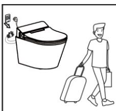
В случае долгого отсутствия необходимости в пользовании устройством, выньте вилку из розетки и отключите подачу воды в гибкой подводке.
