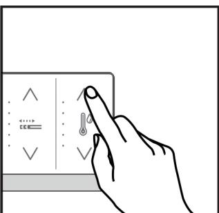
При активной функции «Обмыв» нажмите  $\wedge$ , чтобы увеличить температуру воды; нажмите  $\vee$ , чтобы снизить температуру воды.
