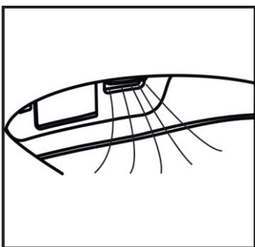
При активной функции «Сушка» открывается специальное отверстие, из которого исходит поток комфорного теплого воздуха.
