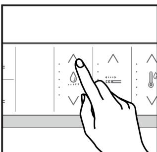
При активной функции «Обмыв» нажмите  $\wedge$ , чтобы увеличить интенсивность потока воды;  $\vee$  – чтобы уменьшить напор воды.
