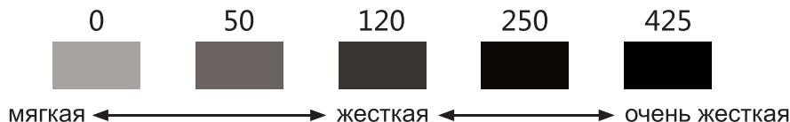
На 1 секунду погрузите полоску под струю воды. Спустя 15 секунд соотнесите появившийся оттенок на полоске с графиком на схеме. Если получилось среднее между двумя значениями, выбирайте то, что больше.
