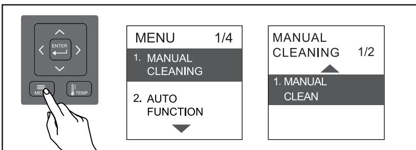
2. Активируйте функцию очистки форсунки согласно представленной схеме на обратной стороне пульта. Форсунка выдвинется без пульсации под водой.
