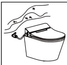
Не подключайте подвод воды к источнику грязной или промышленной воды.
