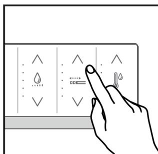
При активной функции «Обмыв» нажмите  $\wedge$ , чтобы форсунка выдвинулась вперед; нажмите  $\vee$ , чтобы форсунка вернулась в исходное положение.
