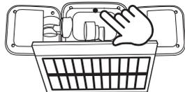
Нажмите на переключатель, чтобы разблокировать встроенную батарею и светильник.
