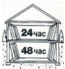
Поместите панели в помещении, где они будут устанавливаться, так, чтобы обеспечить доступ воздуха ко всем их поверхностям. Панели надо выдержать до установки 24 часа, если они устанавливаются в помещении, находящемся выше уровня земли, 48 часов, если в подвальном помещении. Перед началом работы тщательно осмотрите все места, где будут установлены панели, отметьте положение шкафов, арматуры, мыльниц, вешалок для полотенец, электрических розеток и т.д.
