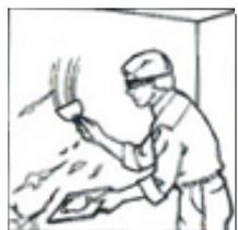
Поверхности стен, на которые устанавливаются панели, должны быть ровными, чистыми, гладкими и сухими. Поверхности зачистить наждачной бумагой. Панели должны устанавливаться на непрерывные твёрдые поверхности – тем меньше расход клея.
