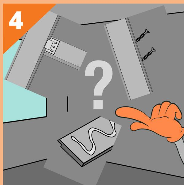
Существуют несколько способов монтажа МДФ панелей: при помощи кляймеров, саморезов или клея.
