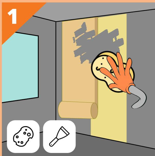
Постарайтесь максимально удалить старую отделку (краску, обои и т.д.). Прошпаклюйте трещины, щели и зазоры при помощи грунтовки, цемента, штукатурки. Так же рекомендуем прогрунтовать поверхность. При необходимости обработайте противогрибковым средством.
