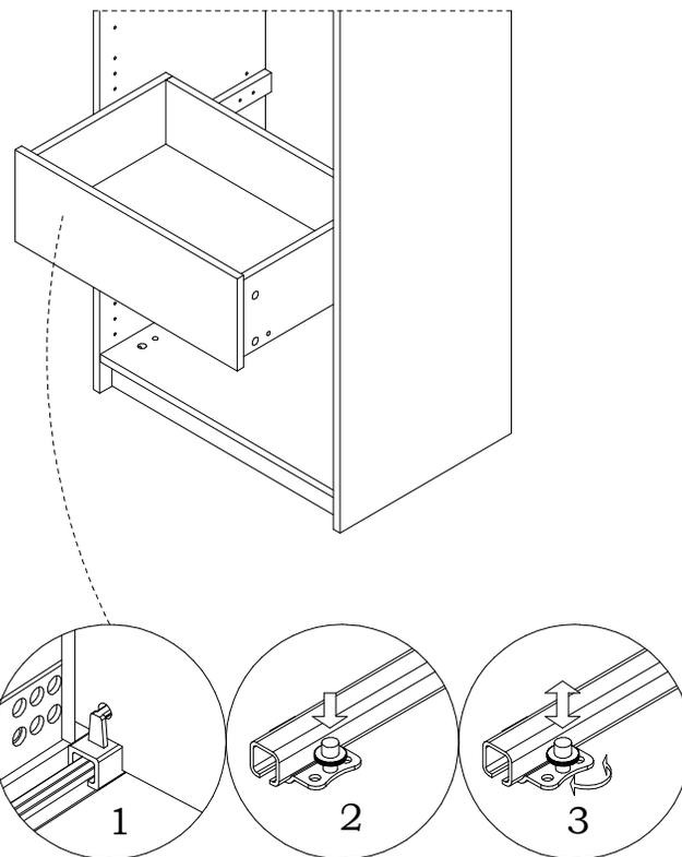
1. Выдвинуть направляющие, вставить ящик под наклоном так, чтобы два отверстия на задней кромке дна попали на крючки;
