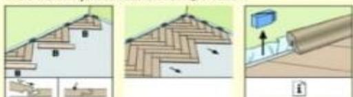
Плинтус. После настила пола, по нему сразу же можно ходить и приступить к дальнейшим работам. Это одно из существенных преимуществ напольного покрытия с замковой системой. Не следует прикреплять плинтус непосредственно к полу, иначе тем самым возможна естественного расширения или скатия настила под плинтусом. В местах, где невозможно разместить профиль или плинтус, температурный зазор следует заполнить эластичной мастикой.
