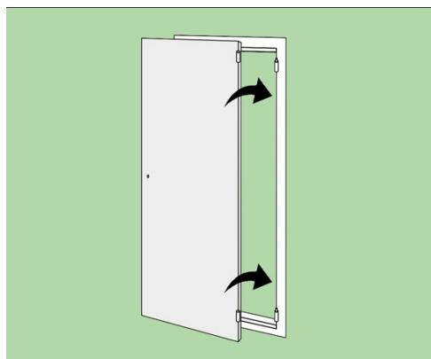
2) Закройте дверь и проверьте работу замков и ручек. Если возникли проблемы, нужно сразу отрегулировать замочную стойку короба по отношению к ригелям замков или ручек с помощью подкладок
