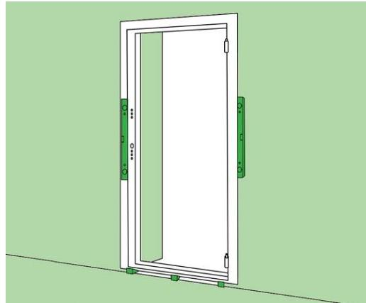
4) Не меняйте положение короба и просверлите отверстия в стене через монтажные отверстия на коробе. Используйте для этого анкерные болты или рамные дюбели и перфоратор.
