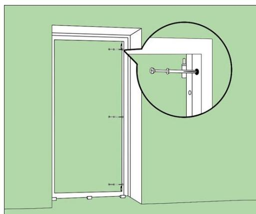
5) Закройте дверь, проверьте вертикаль и горизонталь, ровно ли стоит дверное полотно относительно короба.
