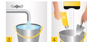
**ВНИМАНИЕ!** Приготовленный раствор рекомендуется использовать в течение 3,5-4 часов. Не допускайте передозировки воды. Это ведет к снижению прочности затвердевшего раствора и образованию трещин.
