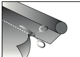
3. Раскатайте рулон обоев только в одном направлении и разрежьте с учетом подгонки рисунка. Используйте специализированный обойный клей, рекомендованный для обоев данного типа. Мы рекомендуем применять клей для виниловых обоев на флизелиновой основе. Следуйте инструкциям производителя, указанным на упаковке.
