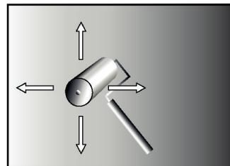
4. Равномерно нанесите однородную клеящую массу на оклеиваемую поверхность. Разгладьте наклеенное обойное полотно специальным валиком или шпателем вниз и от середины к краям до исчезновения воздушных пузырей. Наклеивайте полотна встык. При попадании клея на лицевую сторону обоев, сразу удалите его влажной губкой. Избегайте сквозняков, оптимальная температура в помещении должна быть 18-25 °С.
