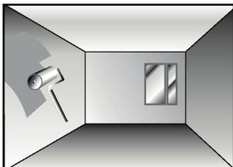
2. Убедитесь, что оклеиваемая поверхность сухая, чистая, гладкая, с хорошо впитываемой поверхностью, нейтральная и однородная по цвету. Удалите со стен старые обои, водорастворимую краску, пятна и грязь. Обработайте оклеиваемую поверхность специальной грунтовкой или обойным клеем.
