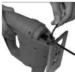
Разблокировка пильного полотна.
