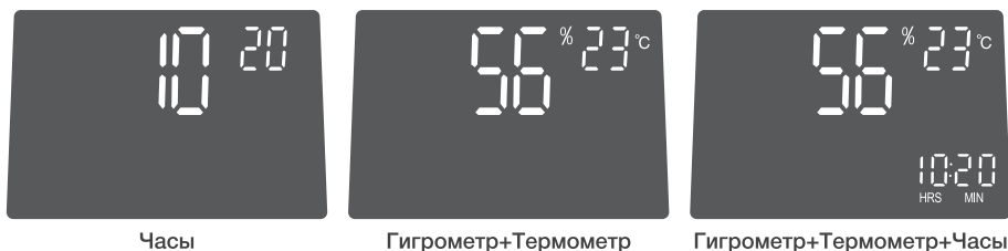
Рис. 5 Дисплей прибора в режиме Метеостанции
