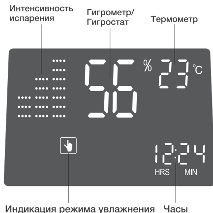
Рис. 4b Стандартный дисплей для режимов увлажнения
