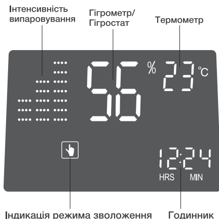
Мал. 4b Стандартний дисплей для режимів зволоження
