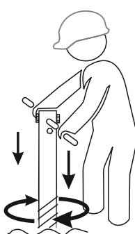
Равномерно распределяйте прикладываемые усилия на оба рычага ключа.
