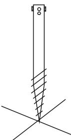
Установите сваю на место монтажа, вдавив её наконечник в землю с усилием, при необходимости накерните небольшое отверстие металлическим прутом.
