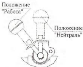
Рисунок 10 – Механизм включения косилки к мотоблоку «Угра».
