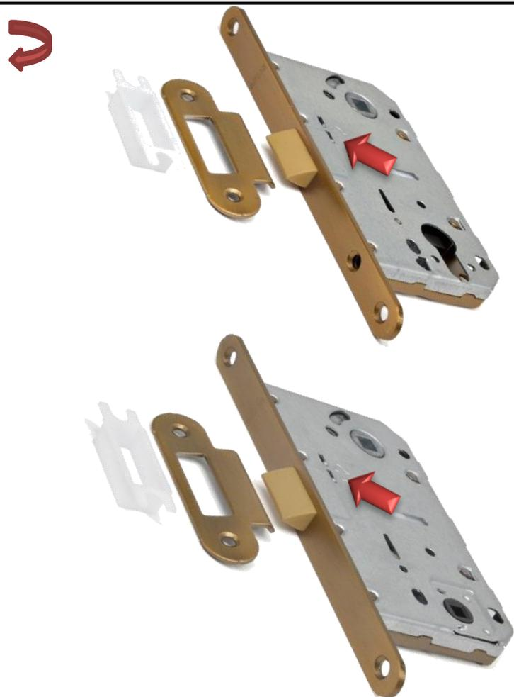
Поднять фиксатор язычка защёлки по направлению указательной стрелки на корпусе защёлки. Перевернуть язычок защёлки.
