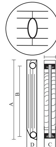
\*Примечание: теплоотдача указана при нормальных условиях – температура воды на входе  $t_{\text{вх}}=91^{\circ}\text{C}$ , на выходе  $t_{\text{вых}}=89^{\circ}\text{C}$ , при температуре воздуха  $t_{\text{возд}}=20^{\circ}\text{C}$ . Тепловой выход (Q) радиаторов при  $\Delta T$  отличающемся от  $70^{\circ}\text{C}$ , пересчитывается по формуле:  $Q = Q_{(\Delta T=70^{\circ}\text{C})} \cdot (\Delta T/70^{\circ}\text{C})^n$ , где  $n=1.30$ .
